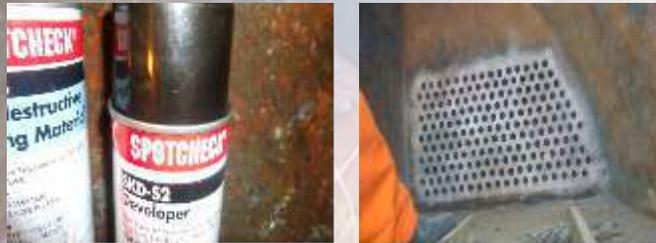
LIQUIDOS PENETRANTES USADOS EN LA INSPECCION ASI COMO APLICACIÓN DEL REVELADOR.
