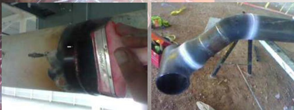
APLICACIÓN DEL PENETRANTE Y REVELADOR EN SOLDADURA
