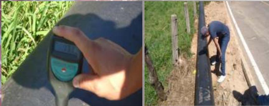
MEDICION DE ESPEOR DE RECUBRIMIENTO DE PINTURA.
