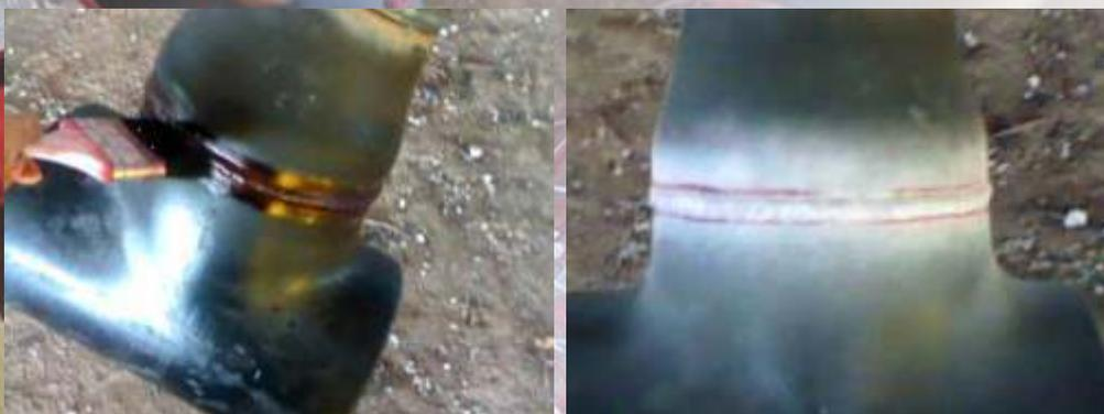
APLICACIÓN DEL PENETRANTE Y REVELADOR EN SOLDADURA.
